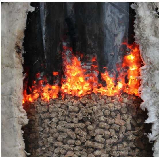
Візуалізація процесу карбонізації та активації біомаси в реакторі з кварцового скла
