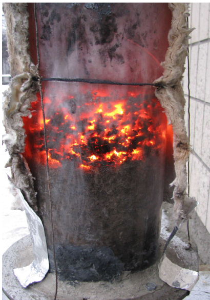
Візуалізація процесу карбонізації курячого посліду в реакторі з кварцового скла
