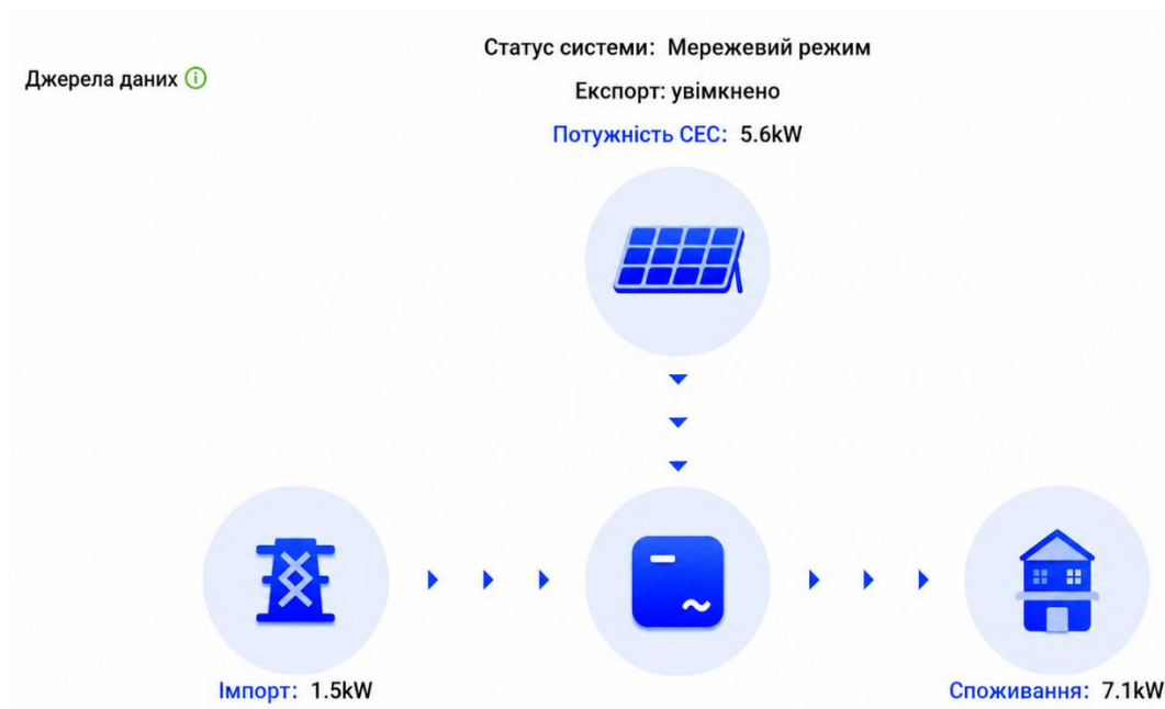
Рис. 2. Інтерфейс моніторингу розподілу електричної енергії
