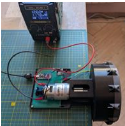
Рис. 1. Загальний вигляд та 3D-модель експериментального стенда: 1 – теплоізоляційний кожух; 2 – кришка; 3 – металевий статор; 4 – ротор із постійними магнітами; 5 – колекторний двигун; 6 – оптичний датчик швидкості; 7 – зовнішній датчик температури; 8 – модуль вимірювання напруги та струму; 9 – мікроконтролер (Arduino Nano).
