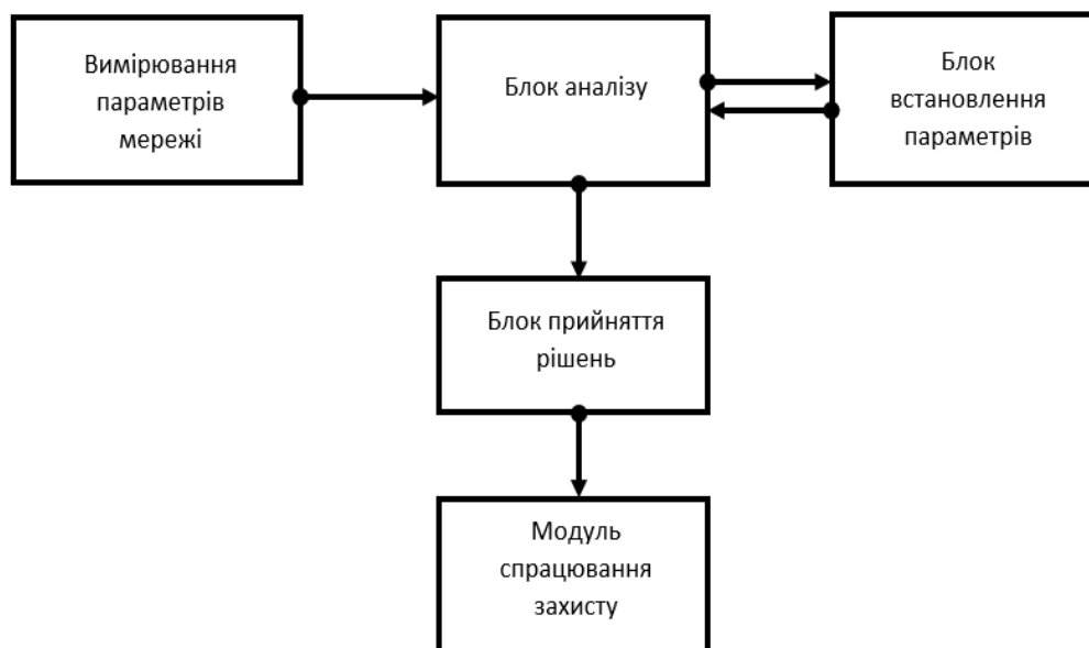
Рис. 1. Структурна схема роботи адаптивного релейного захисту в розподільних мережах середньої напруги з ДРГ.
