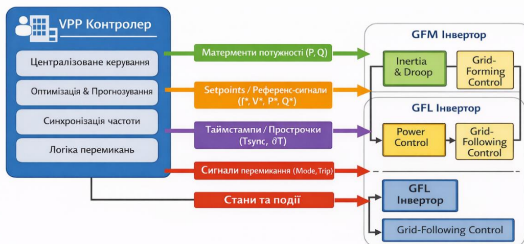
Рис. 3. Архітектура Virtual Power Plant та канали обміну даними з локальними контурами керування інвертор-орієнтованих ресурсів
