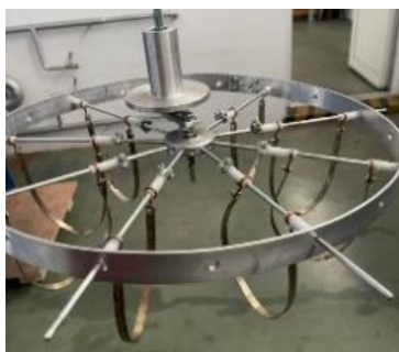
Рис.2 – Загальний вигляд теплового двигуна з термочутливими елементами із сплаву з пам'яттю форми Camital
